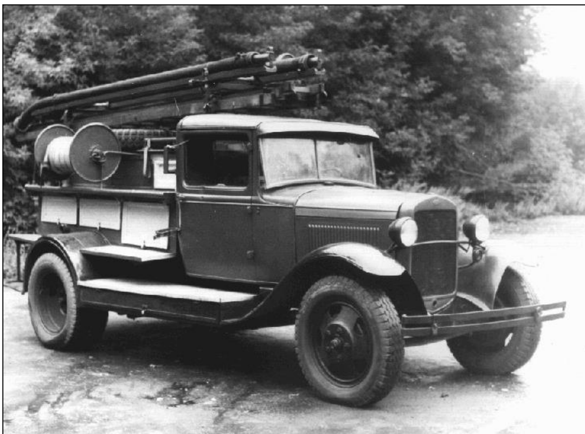
Пожарный автомобиль ПМГ-1 на шасси ГАЗ-АА (1932 г.)
