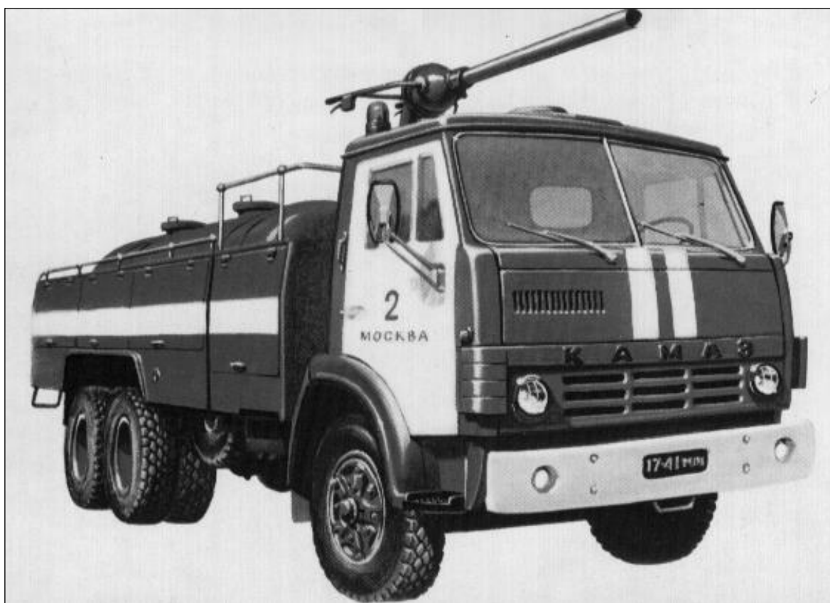
Автомобиль порошкового тушения АП-5 (53213), Модель 196
