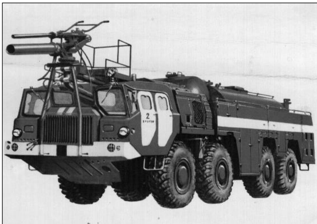
Аэродромный пожарный автомобиль АА-60 (7310), Модель 220 (1970 г.)
